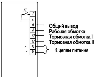
Рисунок 3 — Схема электрическая подключения реле типа РСТ 23-1, РСТ 23-2.
