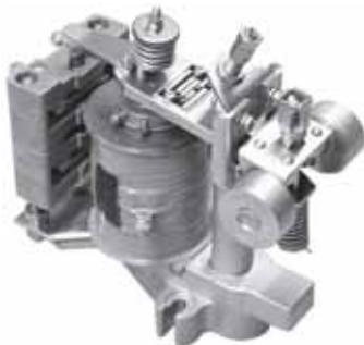
Реле электромагнитные постоянного тока серии РЭМ 200 предназначены для коммутаций цепей в схемах автоматического управления электроприводами постоянного тока и напряжением до 320 В судового электрооборудования и тепловозов.
