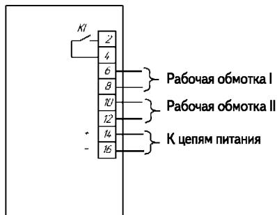
Рисунок 4 — Схема электрическая подключения реле типа РСТ 23-3, РСТ 23-4, РСТ 23-5.
