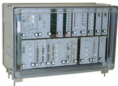
Устройства ЯРЭ 2201, ЯРЭЖ 2201, ЯРЭ 2202 предназначены для установки в комплектные распределительные устройства энергетических установок и тяговых подстанций электрифицированных железных дорог напряжением 6-10; 27,5; 35 кВ и выполняют все необходимые функции защиты и автоматики одного или нескольких присоединений.
