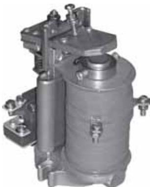
Реле электромагнитные постоянного тока серии РЭМ20 предназначены для коммутации цепей в схемах автоматического управления электроприводами постоянного тока судового электрооборудования и тепловозов (РЭМ 21\*, РЭМ 22\*) напряжением до 320 В.
