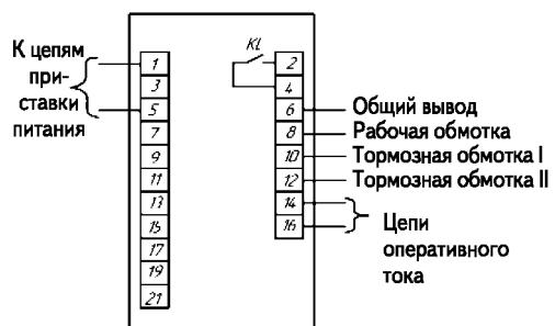
Рисунок 5 — Схема электрическая подключения реле типа РСТ 23-б
