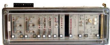
Блоки типов БЭ 1106М, БЭ 1107М, БЭ 1108М предназначены для использования на энергоблоках мощностью 63-1000 MW, при этом:
