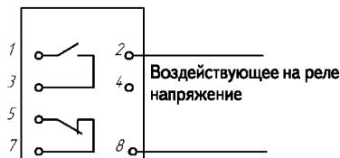
Рисунок 3 – Схема электрическая подключения реле РН 53, РН 54.
